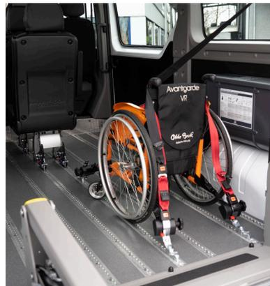
Dieser Hecklift verbleibt im eingefahrenen Zustand in aufrechter Position, wodurch die Platzverhältnisse im Fahrzeuginneren fast vollständig nutzbar sind.
